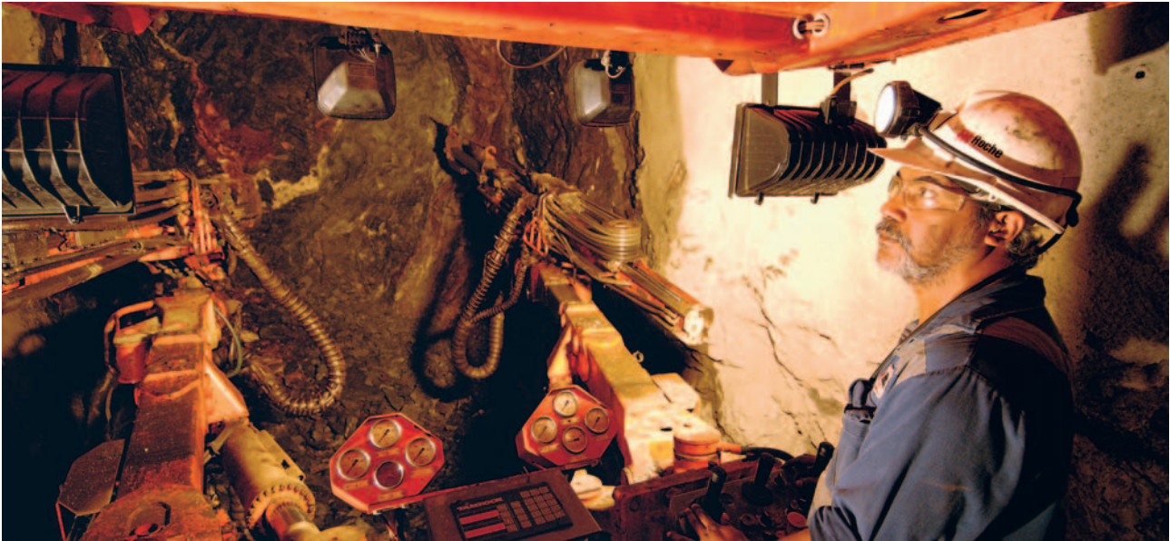
Operator Jumbo Pertambangan Roche, Des Mottlap, mengebor ujung penambangan bijih emas di tambang bawah tanah Cracow.
