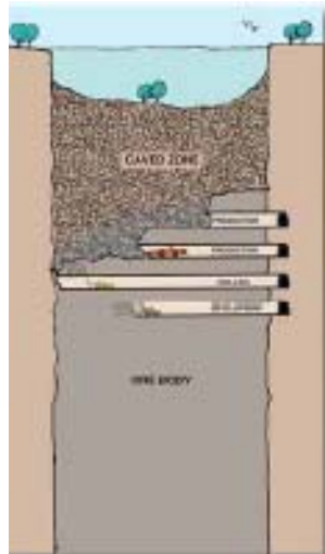
2000 - 2010 Ridgeway Sublevel Caving
